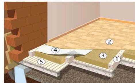
1. Хөндлөвч мод, 2. Хавтан шал, 3. Basaltwool чулуун хөвөн хавтан, 4. Уур тусгаарлагч, 5. Ул модон шал
