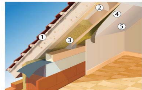
1. Дээврийн дамнуур мод, 2. Салхи тусгаарлагч, 3. Basaltwool чулуун хөвөн хавтан, 4. Уур тусгаарлагч, 5. Гипсэн доторлогоо
