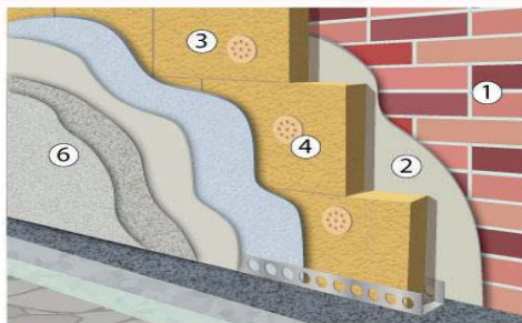
1. Гадна хана, 2. Өнгөлгөө, 3. Basaltwool чулуун хөвөн хавтан, 4. Тааган шаантга, 5. Үндсэн өнгөлгөөний үе ба шилэн тор, 6. Гадна эцсийн өнгөлгөө
