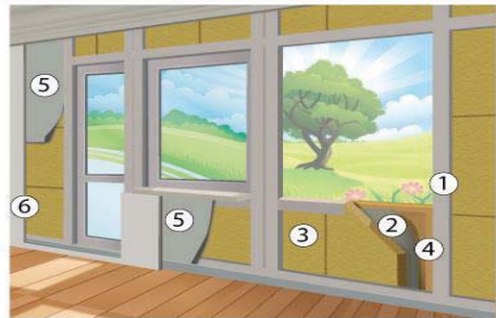
1. Өнгөлгөөний хийц, 2. Салхи тусгаарлагч Тувек, 3. Basaltwool чулуун хөвөн хавтан, 4. Босоо тулгуур, 5. Уур тусгаарлагч, 6. Гипсэн хавтан
